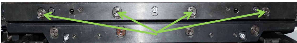
Рис.11. Вид обжимных планок спереди. Указаны 4 цанговые зажима, обеспечивающие зазор между передней и обжимной планками (указаны только зажимы верхней планки, зажимы нижней планки видны прямо под ними).
